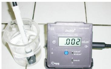
Plus l'intensité du courant qu'une solution laisse passer est grande, plus que la solution est dite plus conductrice.
