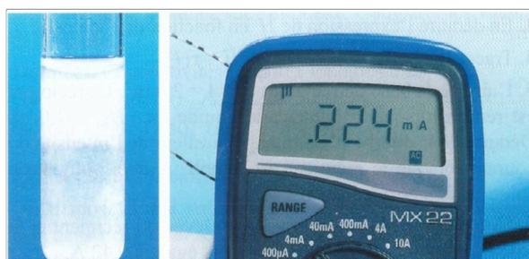
Dans un second temps, on mesure la conductance de la solution au moyen d'une cellule de conductimétrie. Les électrodes sont distantes de  $L = 1,00 \text{ cm}$  et leur surface  $S$  est égale à  $1,00 \text{ cm}^2$ . Pour une tension sinusoïdale imposée et de valeur efficace égale à 2,00 V, l'indication de l'ampèremètre est celle de la figure b.
