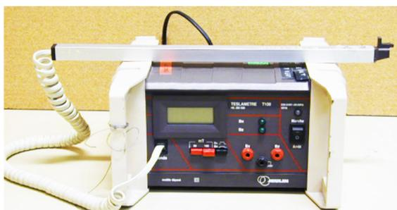
L'intensité d'un champ magnétique peut-être mesurée à l'aide d'un appareil appelé Teslamètre (Doc. 1). Lorsque l'extrémité de la sonde est posée au point d'étude, l'intensité du champ magnétique apparait sur l'afficheur.
