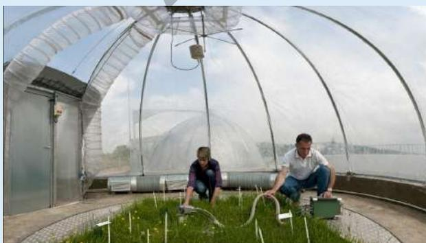
Des chercheurs expérimentent dans un des macrocosmes de l'Écotron européen de Montpellier. Ils mesurent les échanges gazeux entre le sol et l'atmosphère.
